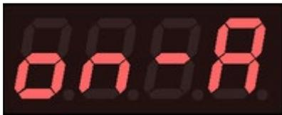
IV. Das Gerät wird durch Alarm ausgeschaltet
